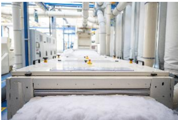
ANDRITZ-Textilrecyclinglinie mittels Reißtechnologie
